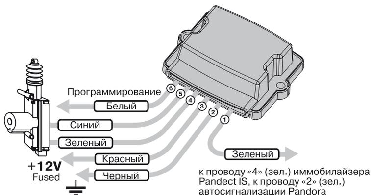
Провод «1» (зеленый) модуля блокировки должен быть присоединен к управляющему проводу «4» (зеленый) иммобилайзера Pandect или к проводу «2» (зеленый) базового блока автосигнализации Pandora.
